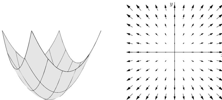
$g(x, y) = x^2 - y^2$  のグラフと勾配ベクトル場  $\nabla g(x, y) = (2x, -2y)$
